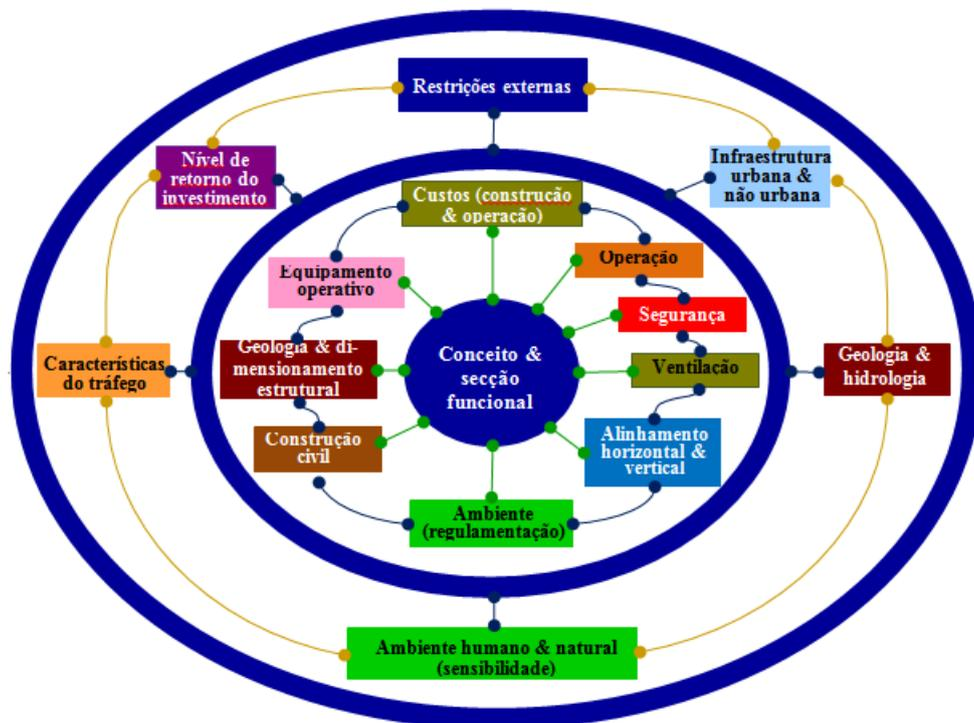
Fig. 3 - Esquema dos principais subconjuntos do "complexo sistema de um túnel"
